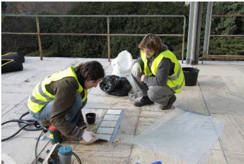
Test odstraňování nečistot z povrchu kamene pomocí obkladů
