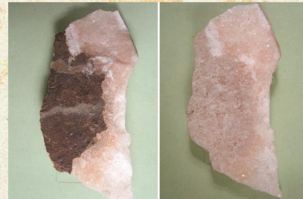
Čierna krusta pred (vľavo) a po (vpravo) aplikácií baktérie Desulfovibrio vulgaris
