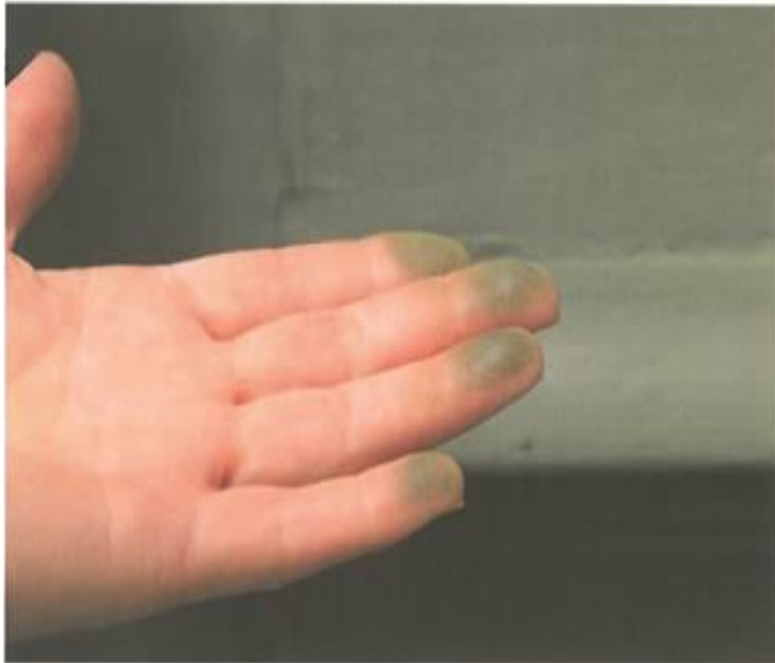
Gealterter Ölanstrich – Bindemittelabbau
