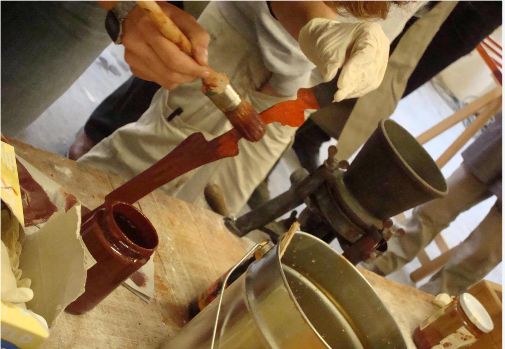
Minium als Korrosionsschutz
