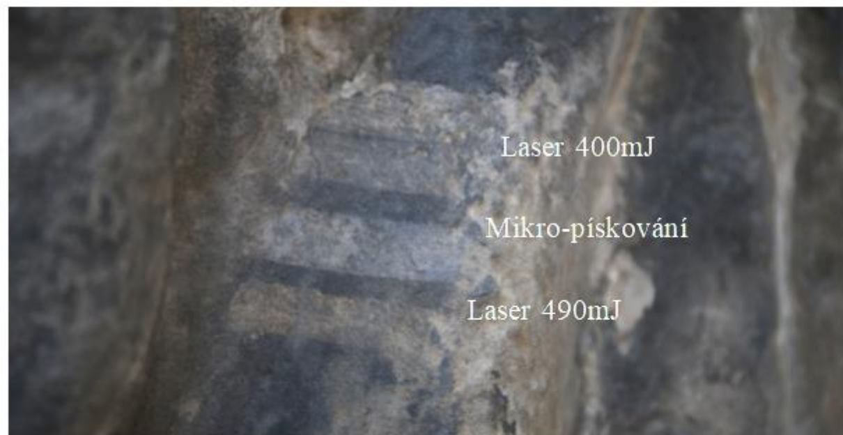
Obr. 16 zkoušky čištění tmavého povlaku.
