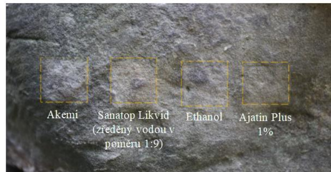
Obr. 15 zkoušky čištění biologického napadení.
