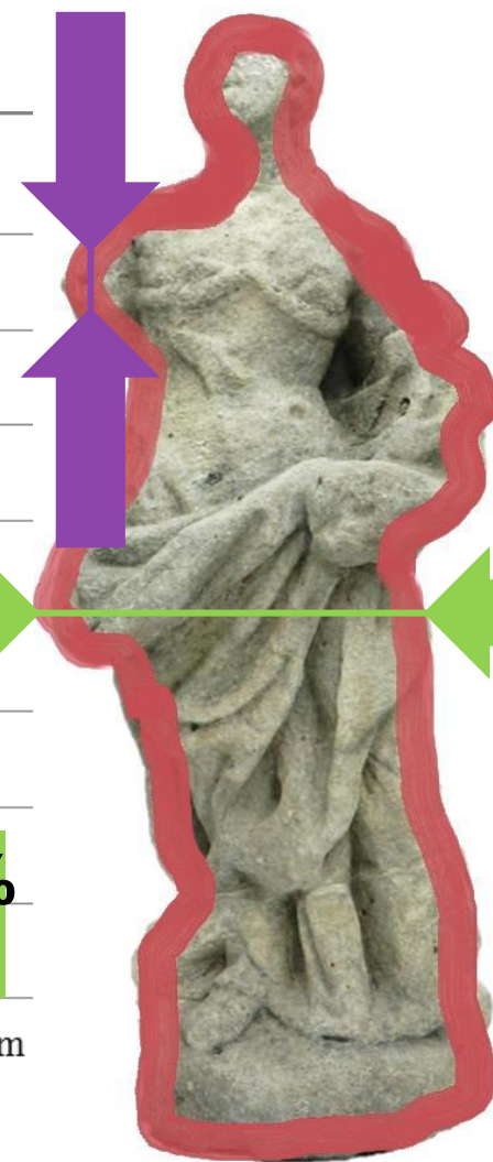
Nárůst rychlostí UZ podle vzdálenosti měření / síly horniny v místě měření
